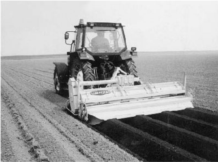
Figuur 3-3: Hakenfreesen kunnen gebruikt worden voor het frezen van aardappelruggen.
