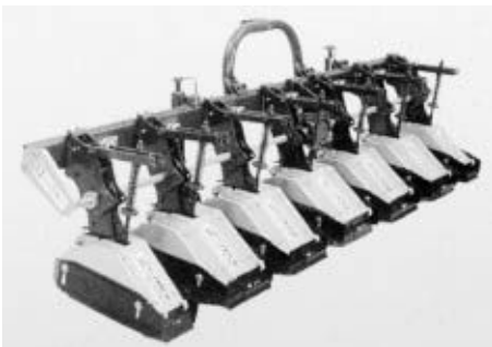
Figuur 3-4: De strokenfrees wordt ingezet voor onkruidbestrijding in maïs.
